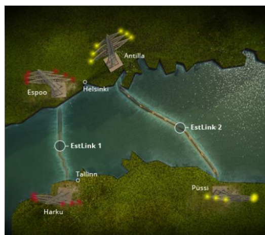
Abbildung 10: Unterwasserkabel „EstLink 1“ und „EstLink 2“
