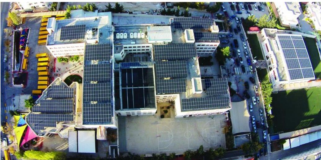
Abb. 15: 420 kWp PV-Installation auf dem Dach der Schule Amman Academy, Projekt implementiert von Mustakbal Clean Tech
