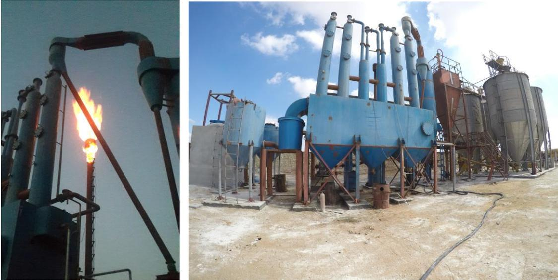
Abb. 24: Biogasanlage für eine Geflügelfarm auf Basis von thermischer Zersetzung (links: die Gasfackel der Anlage nach Inbetriebnahme)
