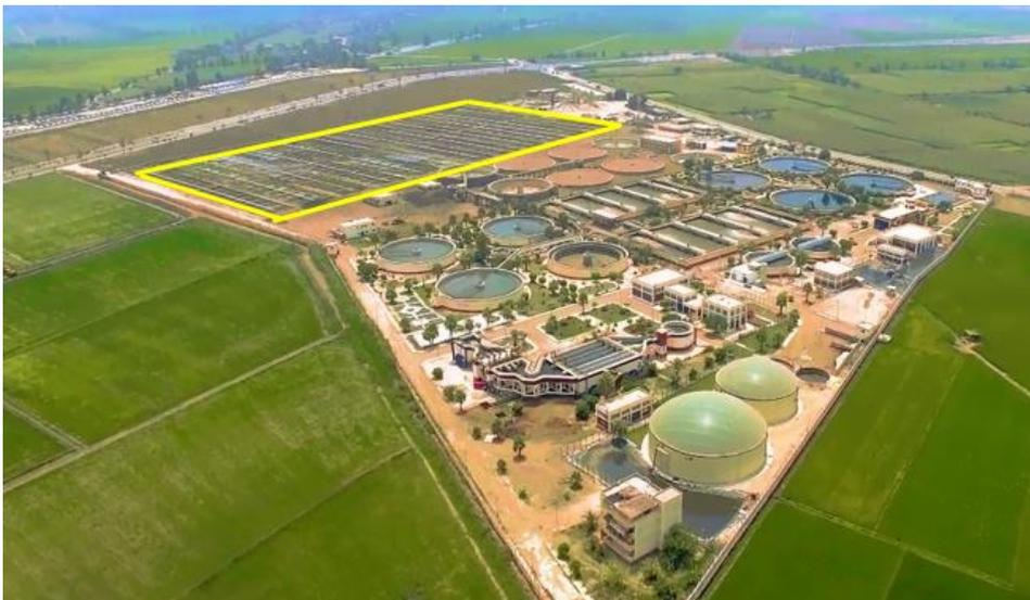
Abb. 20: Luftaufnahme der Biogasanlage von Sakha - Kafr El Sheikh (das gelbe Rechteck kennzeichnet die Fläche der Klärschlamm-trocknung, die nach Fertigstellung der zweiten Phase der Biogasanlage nicht mehr benötigt wird).
