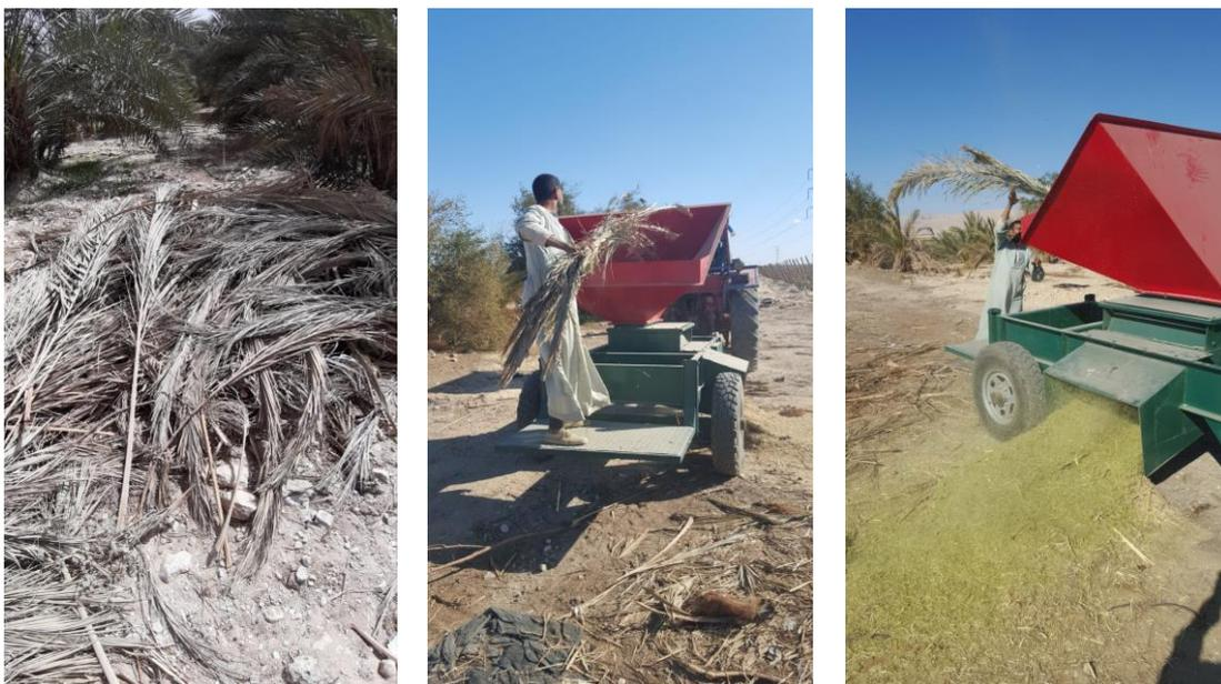
Abb. 21: Zerkleinerung von Palmenzweigschnitten mittels einer traktorgetriebenen Shredding-Maschine auf einem Feld in der Nähe von Luxor [Quelle: Agri-Tech]
