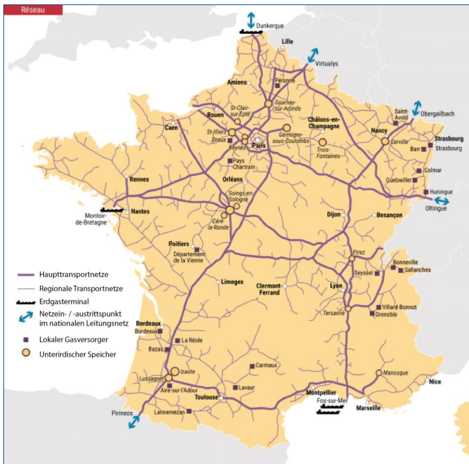
Abbildung 12: Haupttransportnetz und regionales Transportnetz
