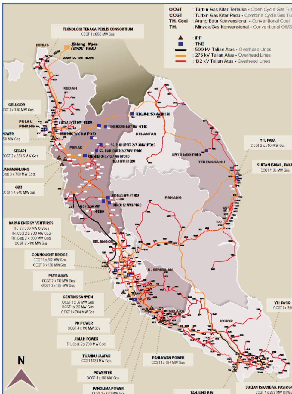
Abbildung 4: Elektrizitätsnetz Peninsular Malaysia
