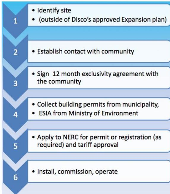
**Abbildung 15: NERC-Genehmigungsverfahren für Mini-Grid-Anlagen im Überblick**
