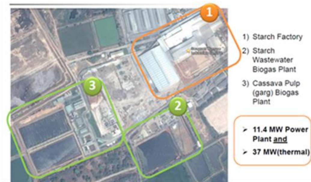
Abb. 41: Übersicht Biogasprojekt bei SWI; Bilquelle: asiaBIOGAS, Januar 2018 106
