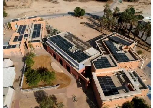
Abbildung 4: Doppelnutzung – PV auf dem Solardach des Regional Council Eilat im Landessüden
