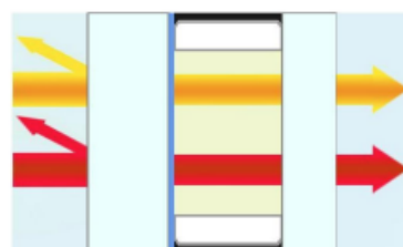
Abbildung 6: Doppelverglasung Quelle: Construction 21 Maroc
