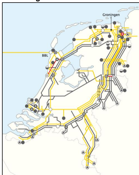
Abbildung 4: Das Gasnetz der Gasunie
