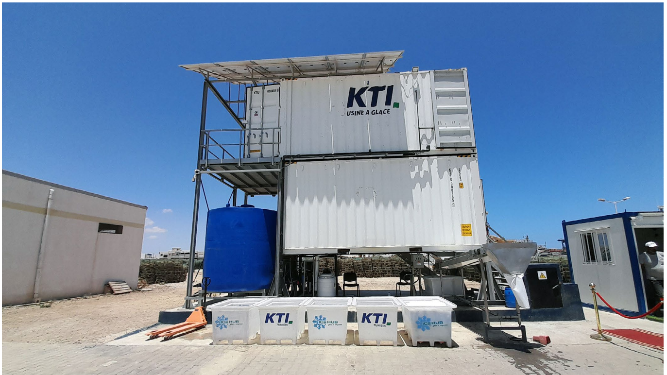
The “FLIP 10” ice machine on the harbour of Zarzis La machine à glace « FLIP 10 » sur le port de Zarzis
